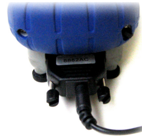
Chargement par l'interface de communication en utilisant l'adaptateur interface D-sub/CC.
