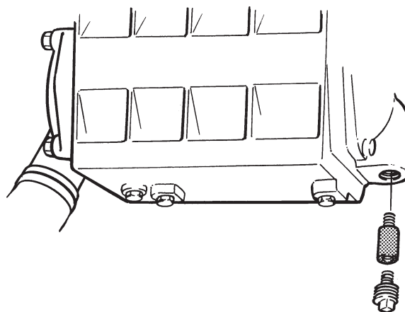
TAMD63, TAMD73 et TAMD74 : Anode en zinc dans le cache d'extrémité avant du groupe cellulaire
