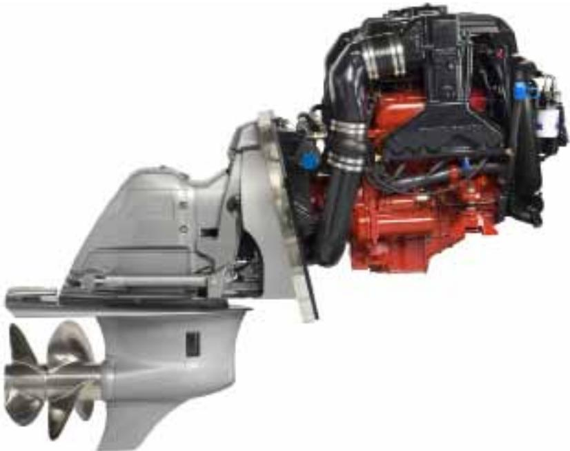
La pompe à eau de mer, le filtre à huile, le filtre à carburant et le réservoir de carburant sont situés à l'avant du moteur pour une meilleure accessibilité de service. Les points d'entretien sont codés en couleur.
