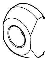
884933 Mandrin Dépose de la bague de roulement sur l'arbre de liaison
